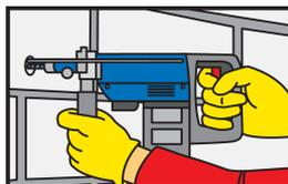
Praticare il foro con il trapano. Il diametro del foro e la barra d'ancoraggio devono in ogni caso corrispondere.
